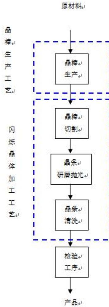
图 3.5-1 闪烁晶体材料总制造工序
